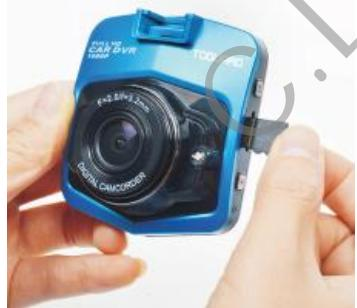
Connectez l'appareil à la prise d'alimentation de la voiture. Lorsque vous allumez la voiture, l'appareil s'allume et commence à enregistrer. Vous pouvez activer et désactiver l'enregistrement à l'aide du bouton OK (2) et verrouiller manuellement une vidéo avec la touche LOCK (7). Lorsque vous éteignez la voiture, l'appareil s'éteint et ferme les vidéos en attente.
