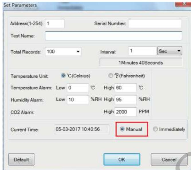
La configuración de los parámetros es la misma que se mencionó anteriormente. La diferencia es que seleccionaremos medición manual. Una vez finalizada la configuración, salga y desconecte la línea de datos y lleve el dispositivo al destino.
