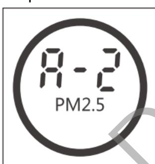
Cuando los filtros estén casi caducados, las luces indicadoras de reemplazo de filtro **P-2** se iluminarán en la pantalla para indicar que los filtros deben ser reemplazados. Si usted no reemplaza los filtros cuando debe:
