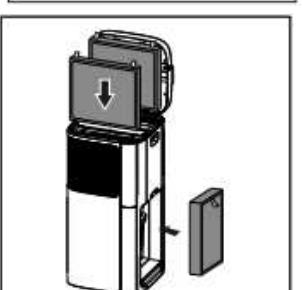
4. Después de que los pre-filtros estén correctamente puestos de nuevo en el dispositivo, resetee el contador de vida del filtro. (Consulte el capítulo 7 "Resetear contador de vida de filtro").
