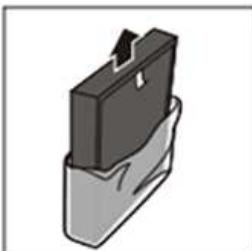
2. Tire de la parte superior del panel lateral para retirarlo del dispositivo.
