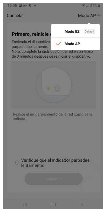
Seleccione arriba a la izquierda el modo AP. Encienda el purificador. Una vez en marcha, pulse la tecla encendido unos 5 segundos hasta que oiga bip. Aparecerá en la pantalla del purificador un icono de señal wifi parpadeando rápido, vuelva a pulsar unos 2 o 3 segundos y hasta que vuelva a hacer bip y el mismo icono parpadeará lento.
