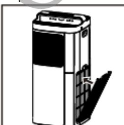
**Nota:** Asegúrese de que el lado con las dos pinzas está apuntando en dirección a usted, y que todos los enganches del pre-filtro están adecuadamente acoplados al purificador.
