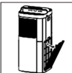
3. Presione las dos pinzas hacia abajo y tire del pre-filtro hacia usted.
